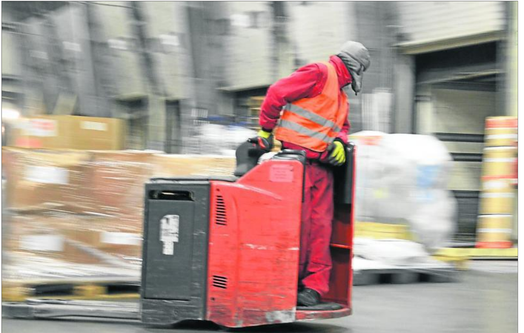
Abholbereit: Mit einem elektrischen Hubwagen werden die Waren von einer der insgesamt drei Hallen in die nächste oder von einem Relationsplatz zum anderen verladen. Fotos: Tobias Farnung
