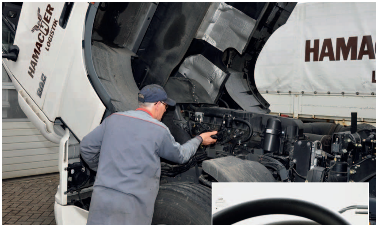
Die Gasanlage wird mit wenigen Eingriffen neben den Dieselmotor gebaut. Verbrauchsanzeige in der Fahrerkabine (rechts).
